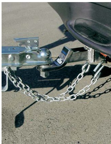
Fig. 3 : Un attachement correct des chaînes de sécurité est essentiel pour la sécurité de la remorque. Remarquez comment les chaînes de sécurité sont croisées.
