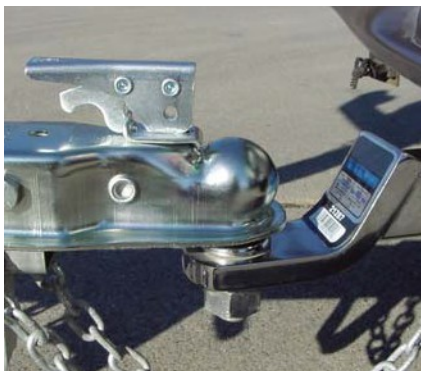
Fig. 2 : Coupleur sur la boule avec loquet en position de verrouillage convenable.
