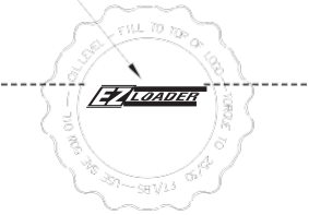
Fig. 18 : Remplissez le niveau d'huile jusqu'au sommet du logo, comme indiqué.
